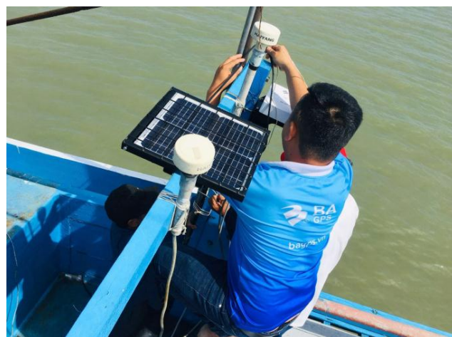
Các chủ tàu Bình Thuận lắp đặt thiết bị giám sát hành trình. Ảnh: VC.
