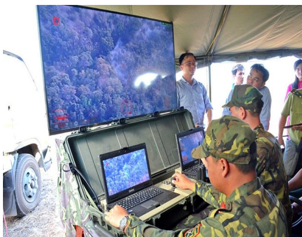
Hình ảnh được truyền trực tiếp theo thời gian thực từ máy bay về Trạm điều khiển mặt đất phát hiện một điểm cháy rừng.
