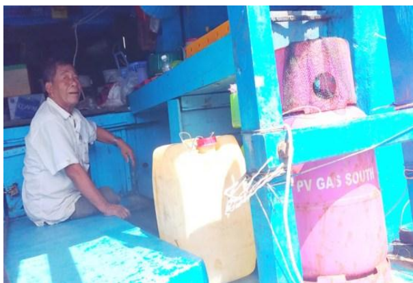
Nhiều bình gas đã gỉ sét, lại để lộ thiên nên rất dễ xảy ra cháy nổ
