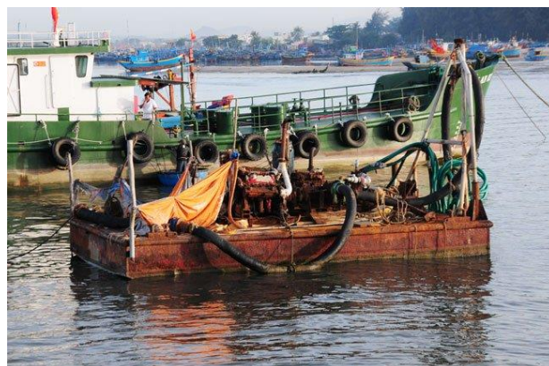
Một chiếc tàu hút dùng để nạo vét cát khu vực cảng La Gi - Ảnh: Văn Nam
